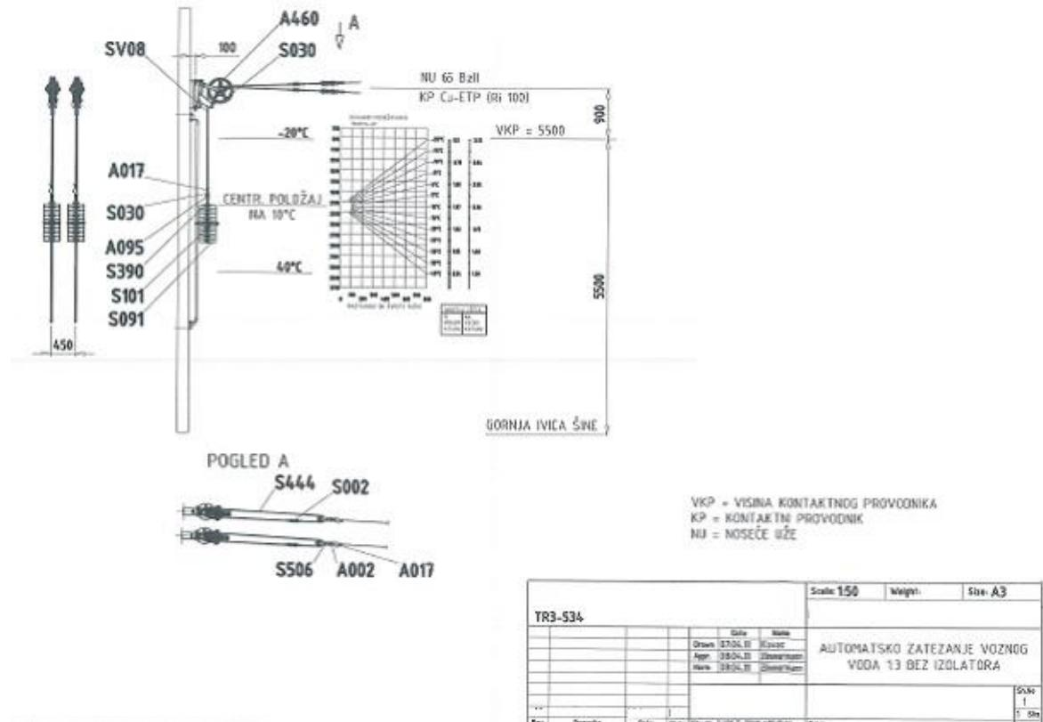
Аутоматско затезање возног вода контактне мреже монофазног система  $25\text{ kV}$ -  $50\text{ Hz}$
