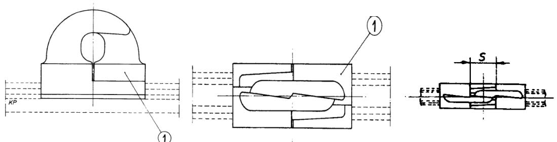
Мера „s“ која се постиже после ручног намештања оба полутела стезаљке на контактни проводник треба да износи 8-10 mm.
