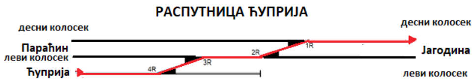
Слика 15. Смер приволе при саобраћају воза од станице Ћуприја и по десном колосеку Распутница Ћуприја → Јагодина
