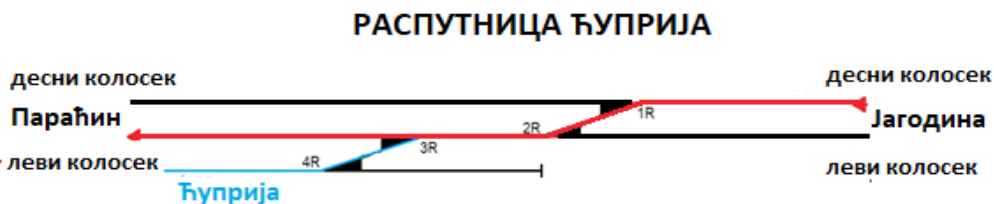
Слика 11. Смер приволе при саобраћају воза десним колосеком Јагодина → Распутница Ћуприја и по левом колосеку Распутница Ћуприја → Параћин
