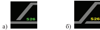
Слика 60: Скретница а) води у правац (зелена боја ознаке скретнице), а скретница б) води у скретање (жути боја ознаке скретнице)
