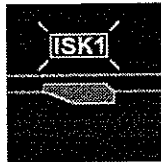
Слика 81. Исклизница је у зависности са скретницом
