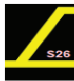
Слика 70: а) скретница је пресечена и њен одсек није заузет, б) скретница је пресечена и њен одсек је заузет
