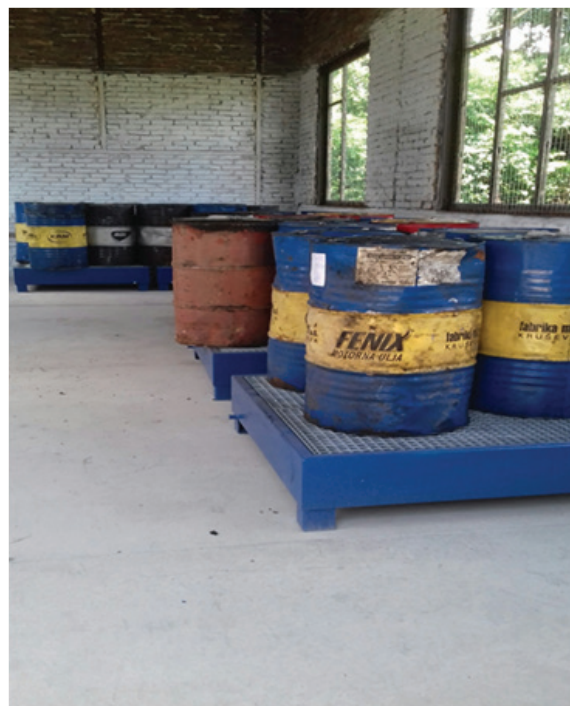
Слика 30. Унутрашњост са танкванама у „Сушари“ у оквиру стоваришта бр. 657
