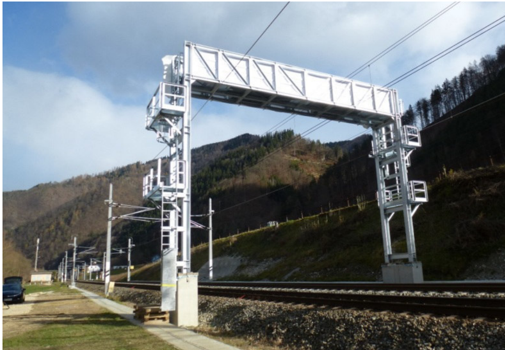
Слика 2.19 Пример реалног уређаја за мерење профила воза
