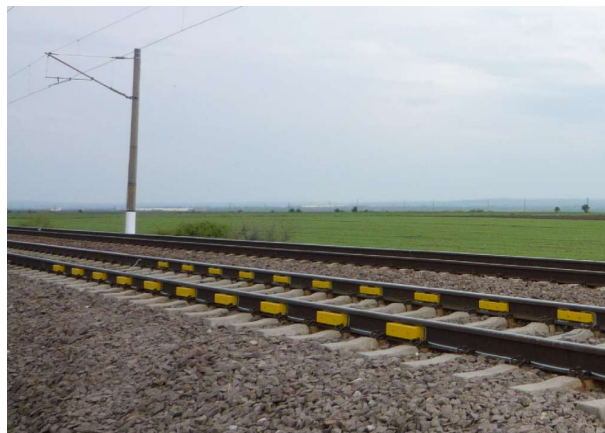
Слика 2.16 Уређај за динамичко мерење масе и равних места на точку
