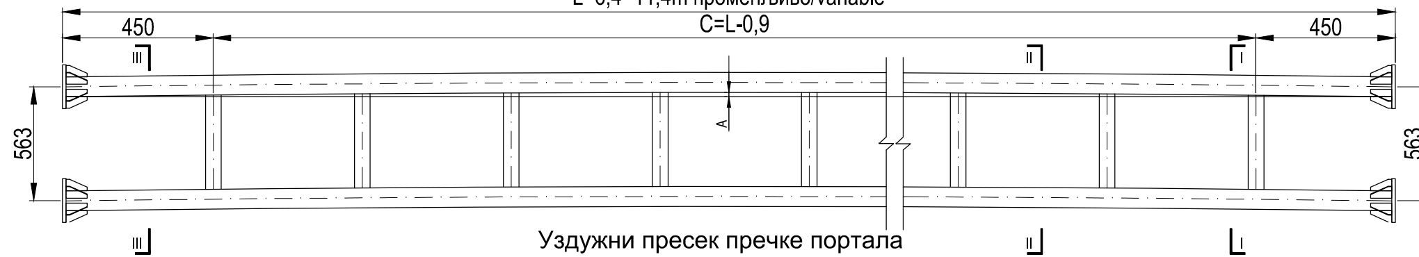
Основа пречке портала Plan Drawing of Middle-Beam L=6,4~11,4m променљиво/variable
