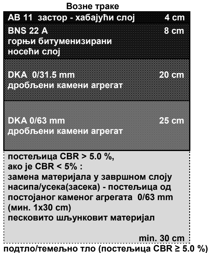
Слика 4. Шематско/графички приказ коловозне конструкције саобраћајници државних путева II-Б реда са средњим саобраћајним оптерећењем
