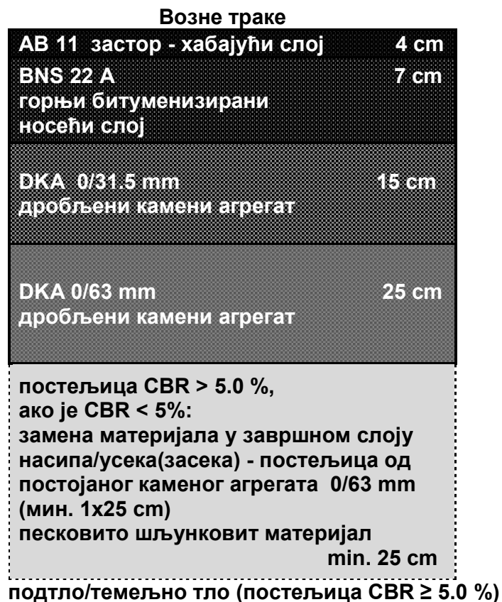
Слика 1. Шематско/графички приказ коловозне конструкције на локалним путевима/саобраћајницама са средње лаким саобраћајним оптерећењем
