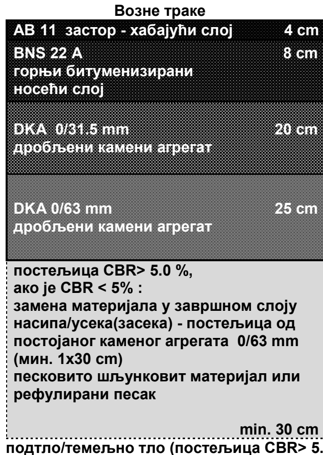
Слика 3. Шематско/графички приказ коловозне конструкције на саобраћајницима са средњим саобраћајним оптерећењем
