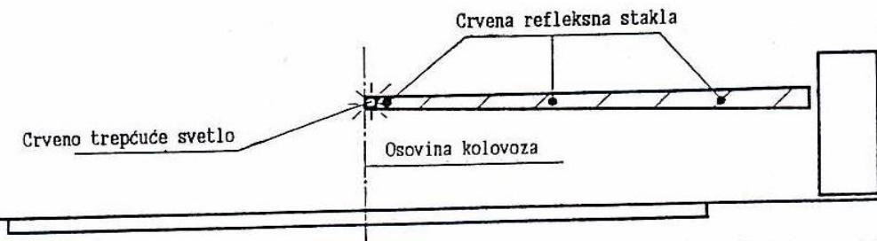
Слика 3. Распоред светлосних знакова на мотки браника ( полубраника) типа L=3,5m и L= 4,5m
