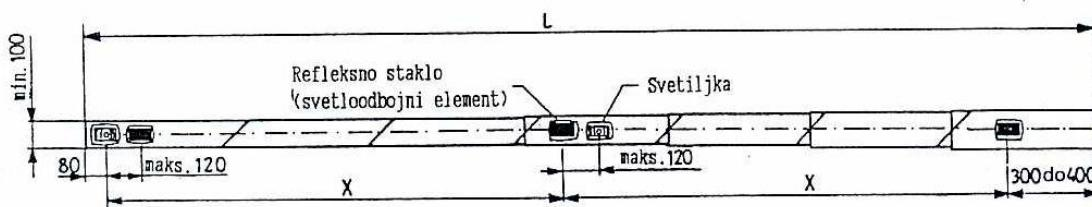
Слика 2. Распоред светлосних знакова на мотки браника ( полубраника) типа Л=7,5м
